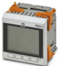
Medidor de energía multifuncional con conexión Rogowski directa e interfaz Modbus RTU/TCP integrada para medir parámetros eléctricos en instalaciones de baja tensión hasta 690 V.
